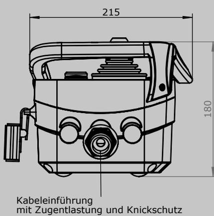
Der Umstellschalter NU 1 wird als Signal- und Meldeschalter in Hochspannungsanlagen eingesetzt. Dieses robuste Schaltgerät besitzt Nockenscheiben aus Isolierstoff welche sich 10°-weise einstellen lassen. Die Konstruktion der Gleichstrom-Schaltelemente ermöglichen das aufeinander stecken von Schaltelementen, welche dann gleichzeitig betätigt werden. Hierzu sind die Bauteile zur Befestigung aufgesteckter Kontakte notwendig.
