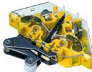
Es können mehrere Schaltelemente aufeinander gesteckt und gemeinsam betätigt werden. Die Flachsteckanschlüsse sind dann nur noch beim obersten Schaltelement zugänglich. Die Schaltelemente können mit einem Berührungsschutz nach DN VDE 0106 Teil 100 ausgerüstet werden.
