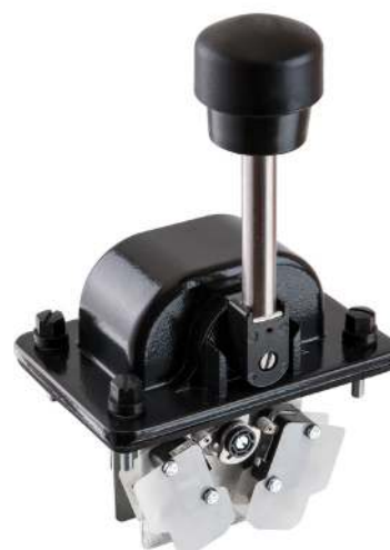
S23L S5 M - 3 Z P - A050 P134 - X Grundgerät S23L Stirnradantrieb links Schalthebellänge S5 -20 mm Griffe / Ballengriffe M Mech. Nullstell.-Verriegelung Achse 1 (Schaltrichtung 1-2) 3 3 Kontakte (2A 250 V AC15) Z Rückzugfeder P Potentiometer Beschreibung Achse 1 (Schaltrichtung 1-2) A050 Abwicklung MSP21-0 P134 Potentiometer T396 2 x 5 kOhm Sonderausführung X Sonder / Kundenspezifisch
